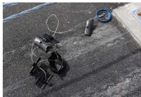
写真 32 車両衝突実験後の状況
