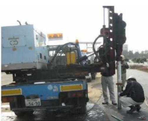
写真 17 支柱打込み機械
