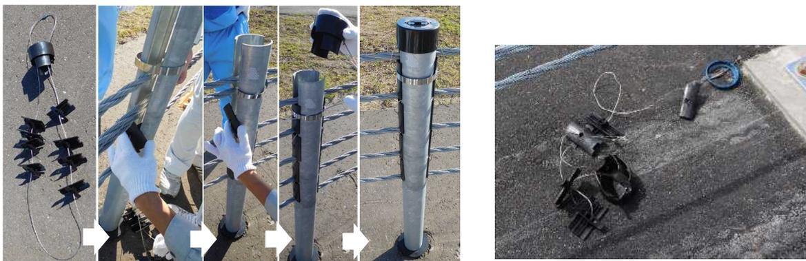
写真 37 孔あき樹脂キャップ、回転式間隔材、飛散防止ワイヤ 写真 38 車両衝突実験後の状況
