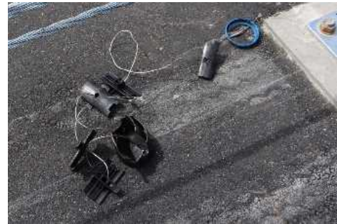
写真 34 孔あき樹脂キャップ、回転式間隔材、飛散防止ワイヤ 写真 35 車両衝突実験後の状況
