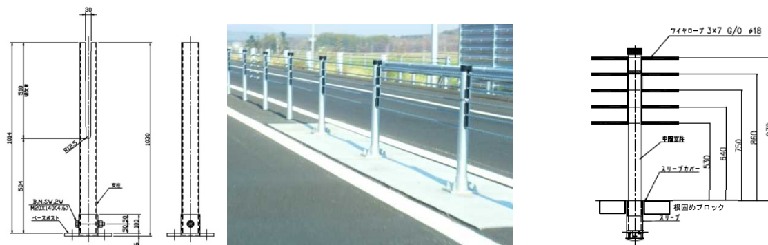
図- 28 低土被りボックスカルバート箇所の支柱構造 (新設) と下部切欠き支柱・短尺スリーブ (既設)
