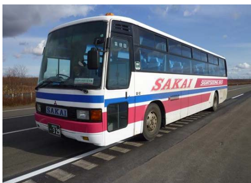
写真6-1. 試験道路における大型車対応ランブルストリップス
