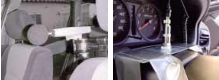
写真 5-7. 車内騒音（左）・車内振動（右）の測定状況
