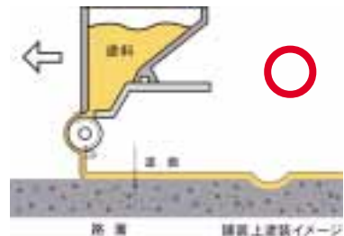
図 4-12. 区画線の施工方法 （シングルロータスプレ式）
