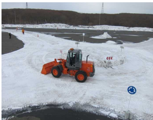
図 5.9 除雪ドーザによる除雪作業
