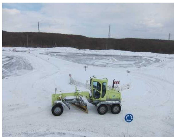
図 5.10 除雪グレーダによる除雪作業
