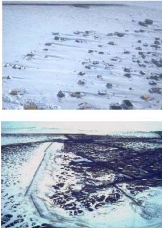
図 2.17 アラスカ州の北斜面にある wainwright 村 (上) 以前の状況 (撮影者 Robert L. Jairell, U.S. Forest Service Research) (下) 柵高 4.6m の柵が 1982 年に設置された (撮影者 Dr. Carl S. Benson, Geophysical Institute, University of Alaska - Fairbanks)
