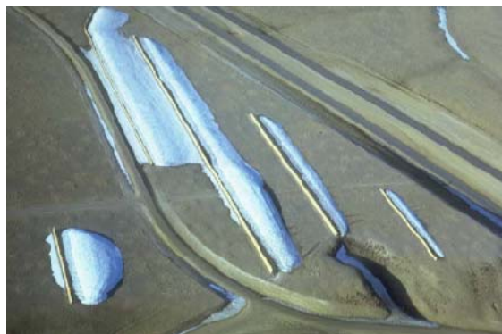
図 2.7 防雪柵設置前のワイオミング I-80, 280.8 マイル地点の積雪状況(左)と,防雪柵設置後 31 年間の続いた積雪状況(右上).この地点の空中写真(Tabler 1973a)
