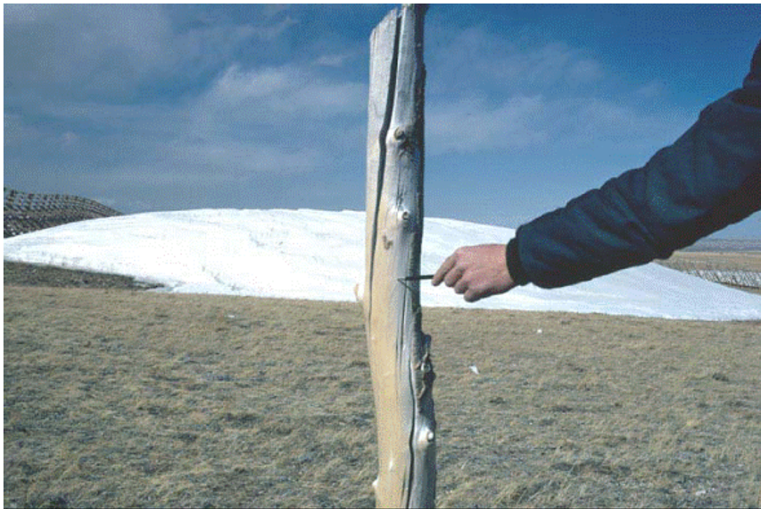
図 4.7 木の棒の摩滅模様は、吹雪時の卓越風向を示している (Tabler 1986)。
