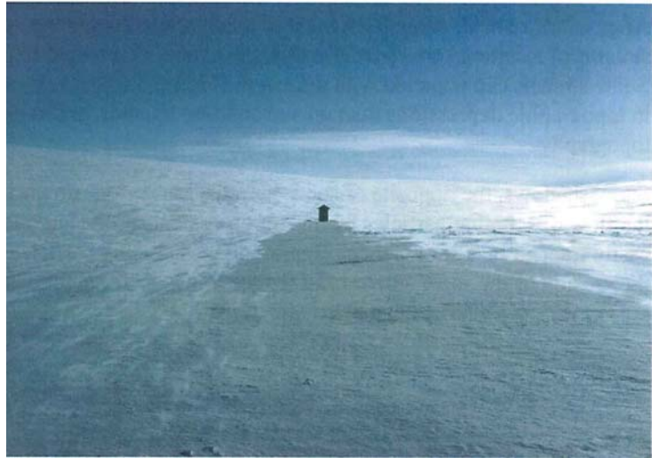
図 3.7 直径 1.2m(4 フィート)、高さ 2.1m (7 フィート) の円柱状シェルターによって形成された雪の影 (タブラー1986)。この写真は、風下 150m (500 フィート) の地点直下から、U.S.フォレストサービスの Robert L.Jairell によって撮影された。
