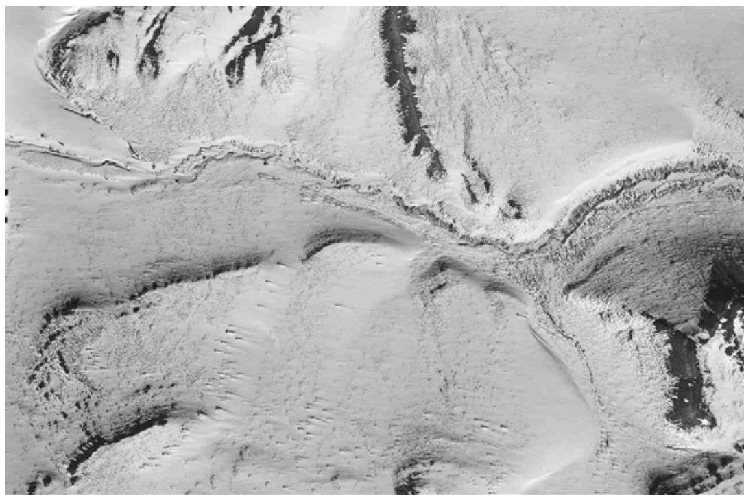
図 4.8 縮尺 1/12000 の航空写真から、大きな灌木や地形の背後に形成された吹きだまりの形成状況がわかる。
