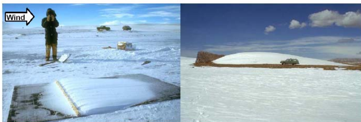
図 3.40 柵高 1.8-m の防雪柵の縮小モデル(柵高 6cm) (写真左)によって形成された平衡状態の吹きだまりは、柵高 3.8m の柵によって形成されたものに比例している (Tabler 1986)
