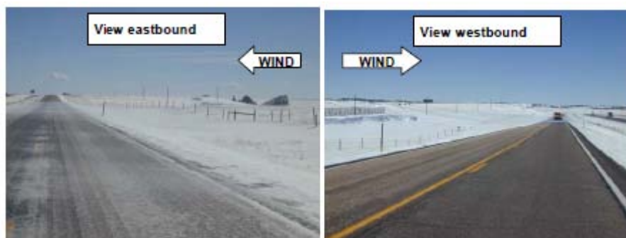
図 2.16 図 2.15 が計測された際の露出路面状況 雪氷路面（左）と乾燥路面（右）との間に図 2.14 の矢印で示した 7～8℃の温度変化がある。
