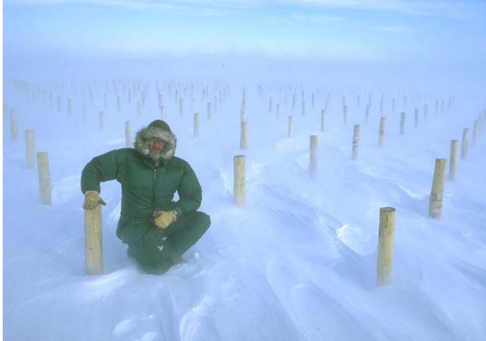
図 3.23 直径 130mm、高さ 1.2m、間隔の異なる柱で保持された雪。表面の粗さの形状が雪の堆積をいかに制御するかを示している (Tabler 1994)
