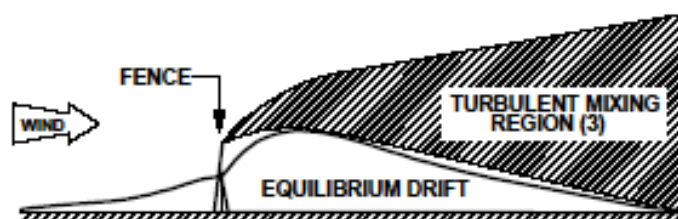
図 3.39 平衡雪丘の表面は、空隙の無い防雪柵後方の主要混合領域(領域 3、図 3.28)の下側境界に沿う (Tabler1994)
