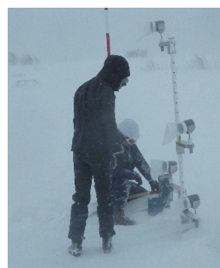
▲図2 ネット式吹雪計による計測状況 Fig. 2 Measurement using a net-type blowing-snow trap meter
