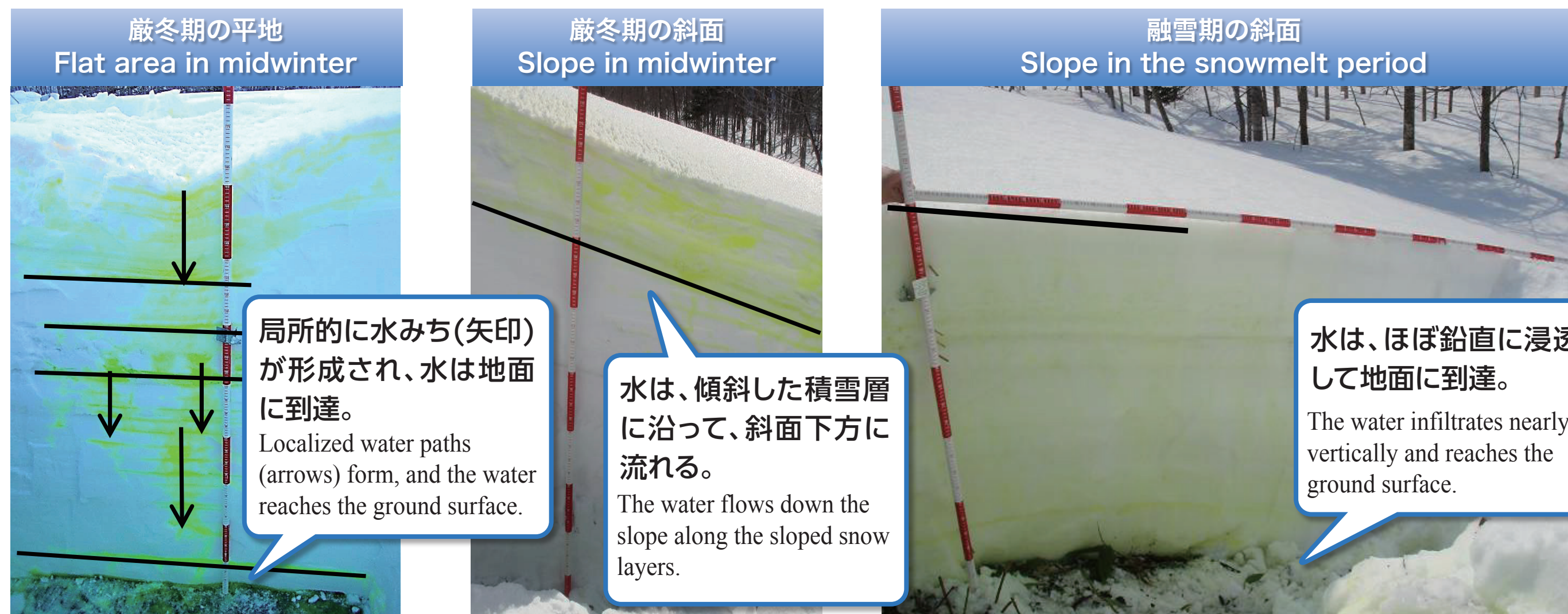
▲色水を使った積雪内部の水分移動に関する現地調査例 Example of onsite survey for water movement inside the snow cover using colored water
