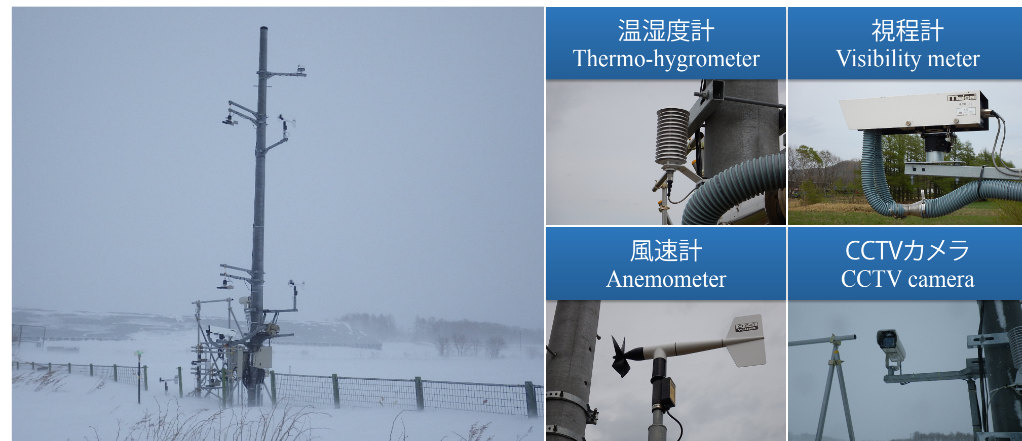
▲各種気象観測。風速計や温湿度計、視程計、日射計などによる気象観測を実施している。 Weather observation using a variety of equipment. We have been conducting weather observation by using anemometers, thermo-hygrometers, visibility meters, and actinometers.
