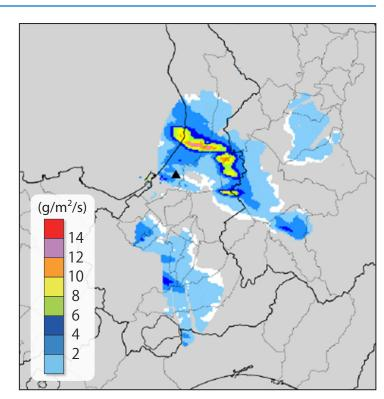
▲図7:レーダを用いた上空の飛雪流 量の推定結果の例
