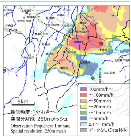
▲図4:XバンドMPレーダの性能 Fig. 4 Performance of the x-band MP radar
