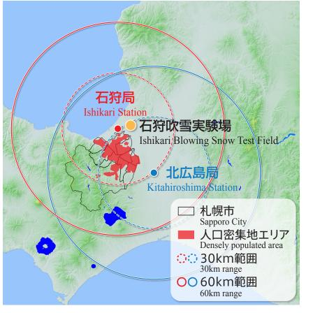
▲図3:XバンドMPレーダの観測範囲 Fig. 3 Observation ranges of the x-band MP radar
