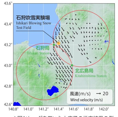
▲図6:レーダを用いた上空風の推定結果の例 Fig. 6 An example of the estimation of wind conditions in the sky using radar
