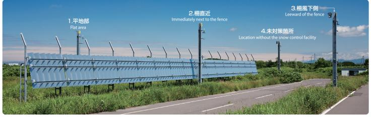
本システムは4本の観測塔で構成しており、観測塔は吹雪の発生する平地部、防雪柵 直近、柵風下側、柵未対策箇所に設置しています。
