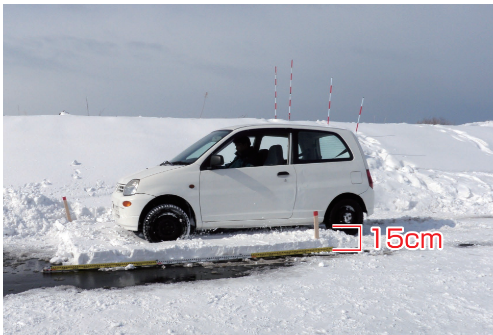
▲吹きだまり深さ 15cm：発進可能
