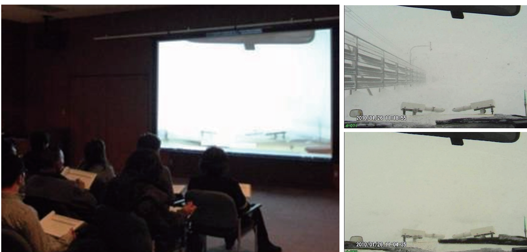
▲吹雪時の道路映像を用いた吹雪視程障害度の評価実験 Experiment on snowstorm-induced poor visibility rating using road images
