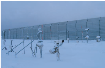
▲標準型の吹き止め柵を用いた防雪効果の測定
