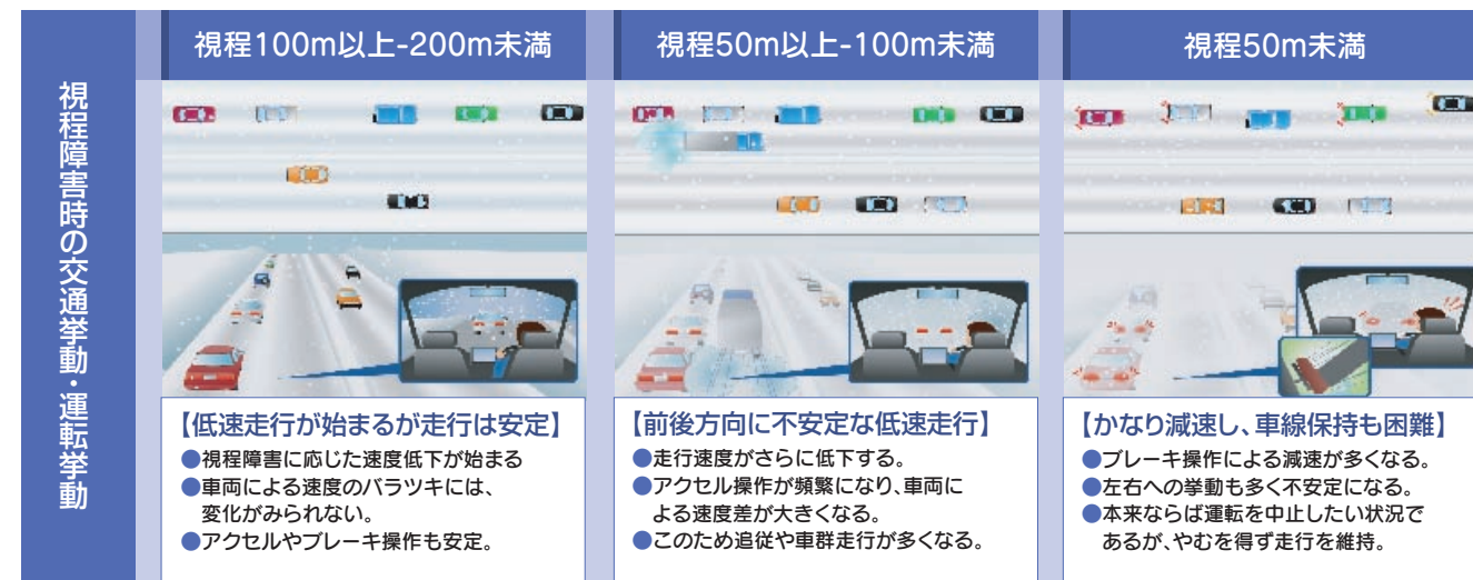
▲視程障害時の交通挙動・運転挙動
