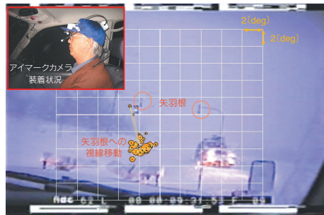
▲アイマークカメラによる視線挙動観測(国道276号喜茂別町)
