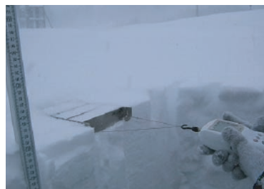
▲積雪の剪断強度測定
