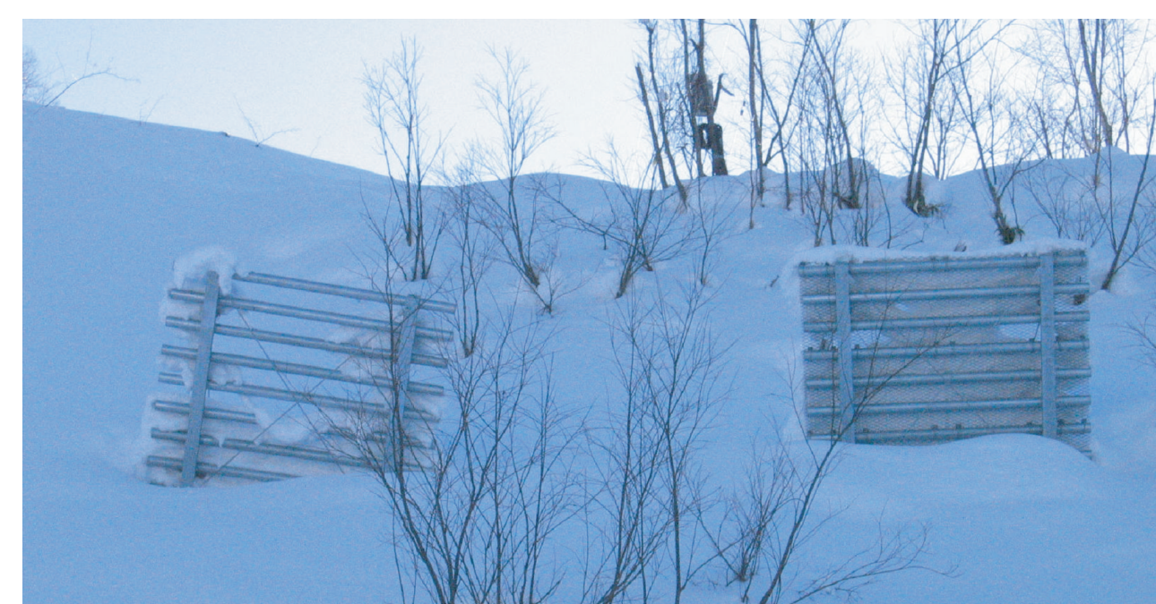
▲鋼製メッシュパネル(右側)を用いた対策試験 Field test of the steel-mesh avalanche fence (right)
