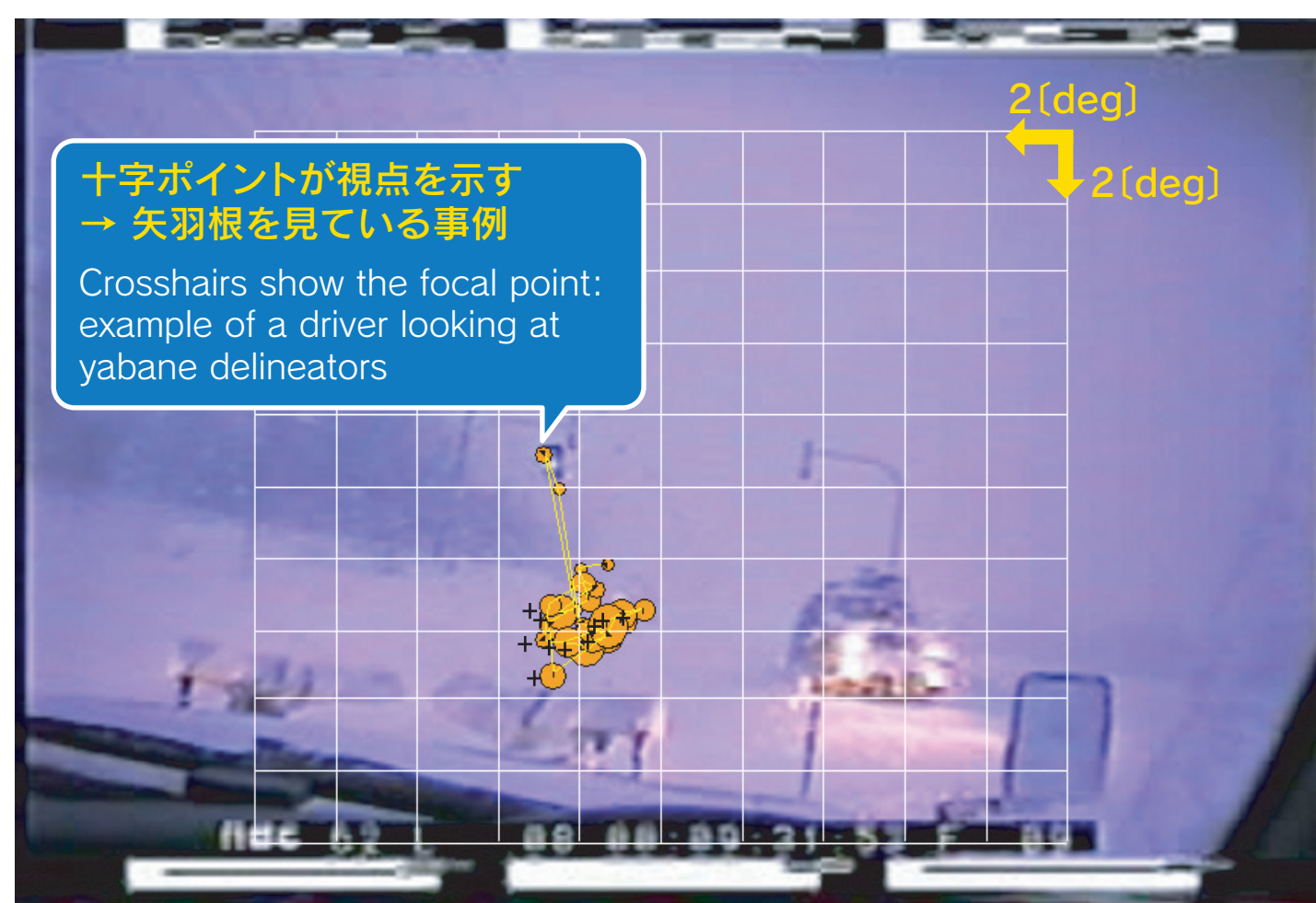
▲矢羽根への視線挙動観測データ Optokinetic surveys on yabane delineators
