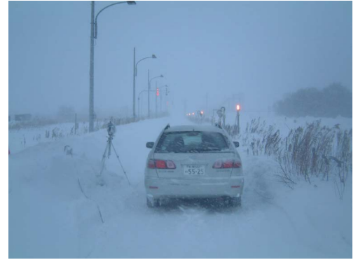
視線誘導施設の視認性調査状況
