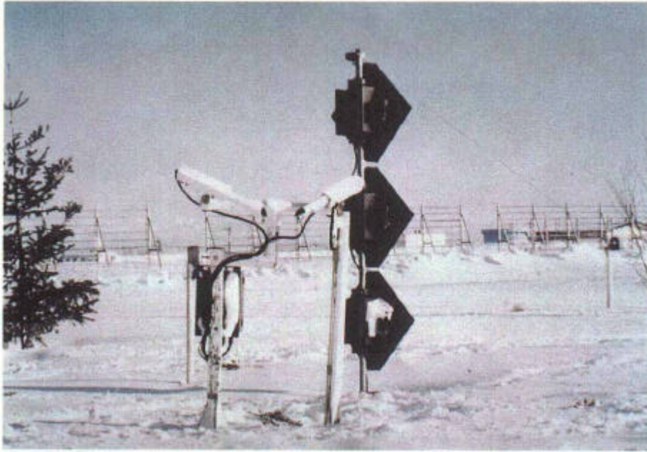
写真 4.2.2 車載型視程計の検証試験状況 (石狩吹雪実験場)
