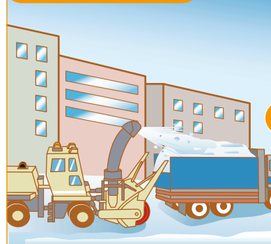
拡幅除雪・運搬排雪
