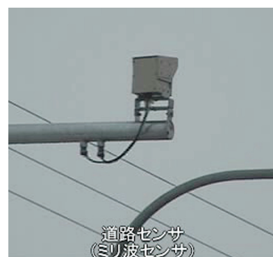
図7 実験機器の設置状況(左：自発光視線誘導標、中：路側情報板、右：道路センサ(ミリ波センサ))
