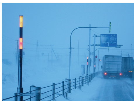
図7 実験機器の設置状況(左：自発光視線誘導標、中：路側情報板、右：道路センサ(ミリ波センサ))
