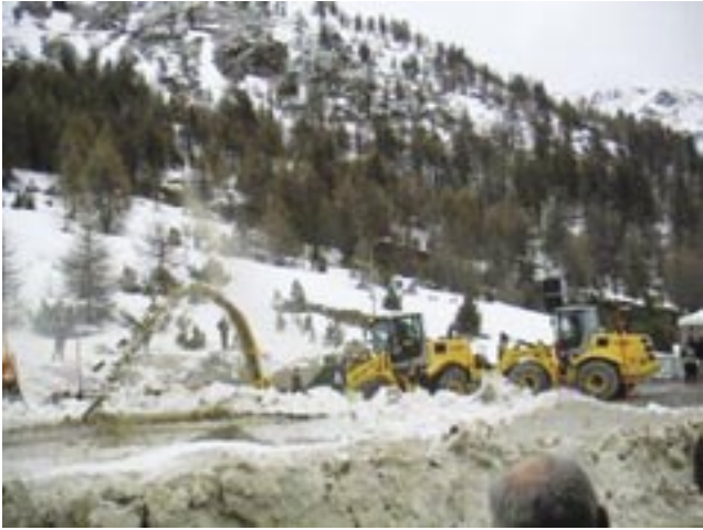
写真-13 ロータリー除雪車 (除雪ドーザーにロータリーを装着)
