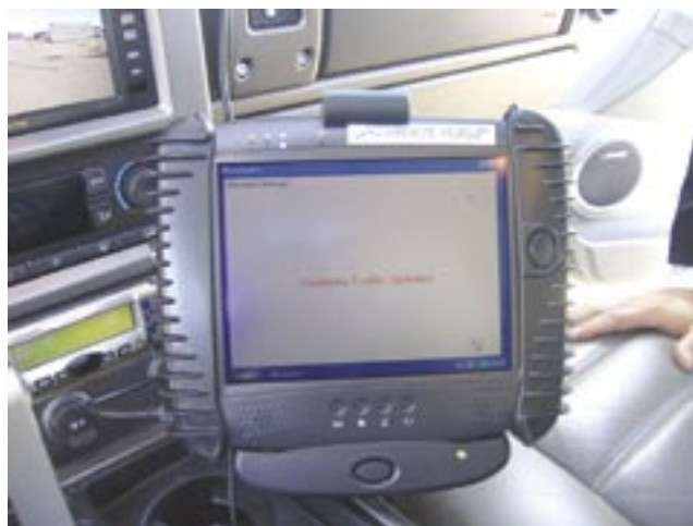
写真-4 OSにウィンドウズを用いた車載端末
