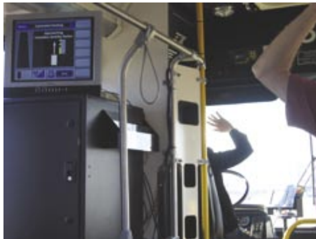
写真-3 自動運転中の様子。ドライバーが両手を離している。液晶パネルには(automated docking)の文字が見え、停留所に向けて自動的に停車しようとしている。
