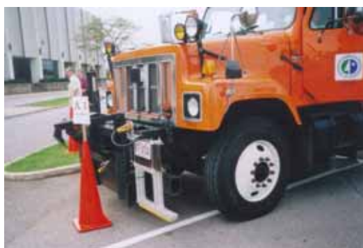
写真5 自動走行のためのプローブ
