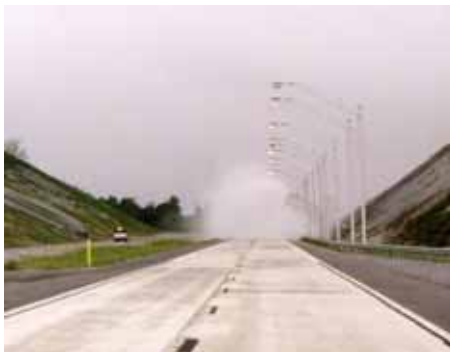
写真2 スマートロードの人工降雨（降雪）機
