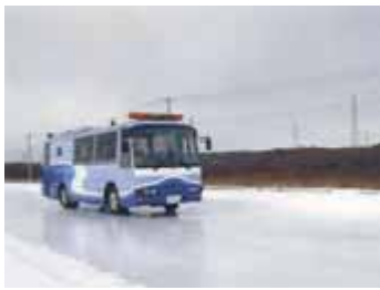
▲ 苫小牧寒地試験道路の全景 (左) とすべり試験車実験 (右)
