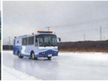
▲ 苫小牧寒地試験道路の全景(左)とすべり試験車実験(右)
