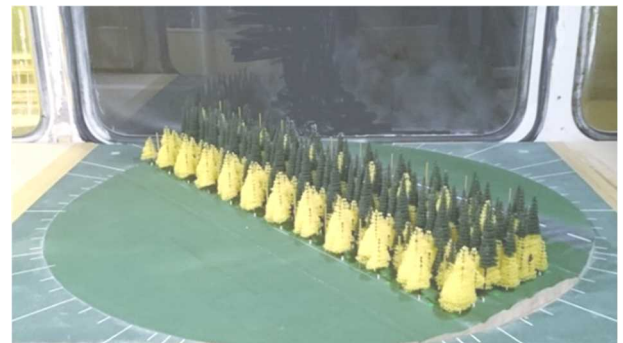
図-49 風洞実験装置のターンテーブルと防雪林模型
