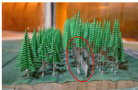
図-102 ネット柵林帯中央設置
