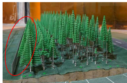
図-103 ネット柵林帯風上設置
