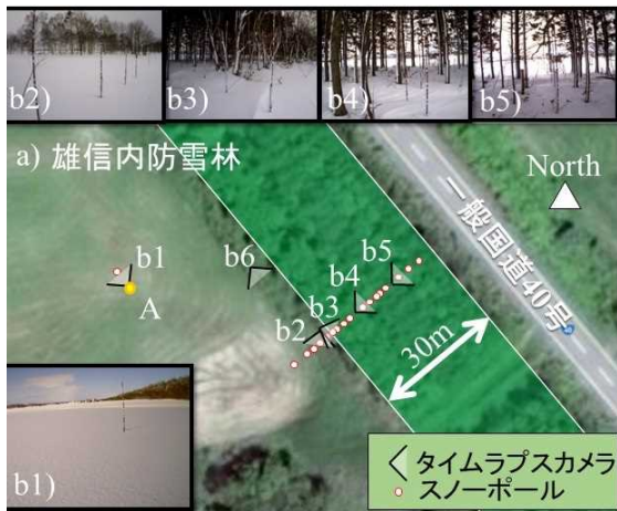
図-152 吹きだまり観測の概要図
