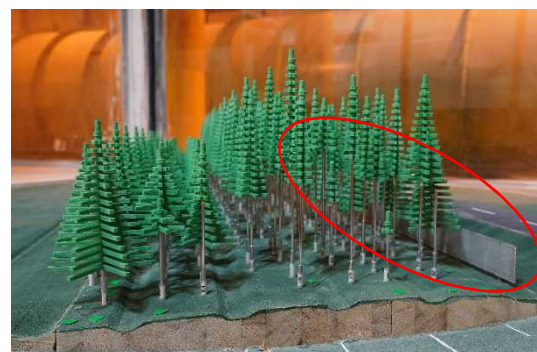
図-104 ネット柵林帯風下設置
