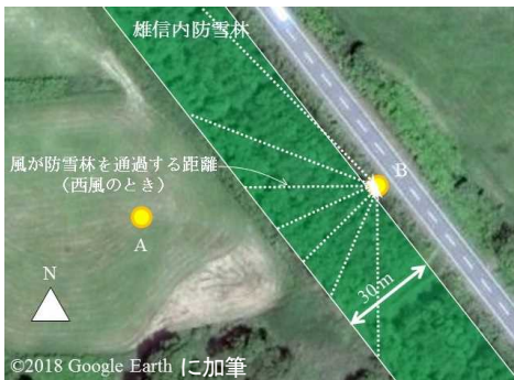
図-39 風が防雪林を通過するときの距離
