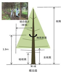
図-4 測定項目の詳細と測定状況（上部写真）
