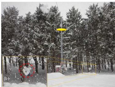
図-34 降雪を伴う吹雪時に撮影した、(a)樹木に付着した冠雪、(b)冠雪からの飛雪（落雪）
