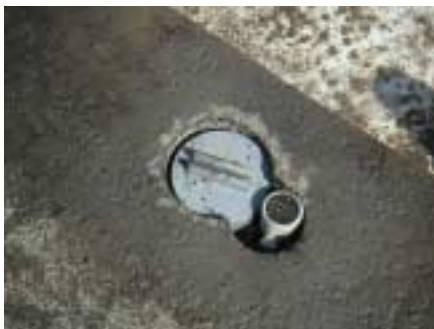
路面に埋設する凍結感知センサー
