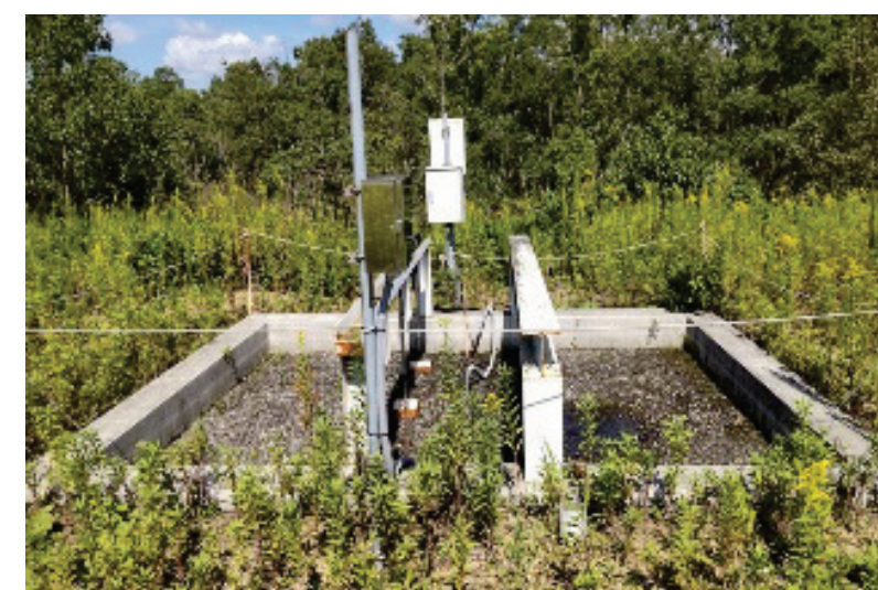
⑬凍上計測用土槽
