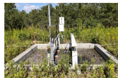
⑭凍上計測用土槽
