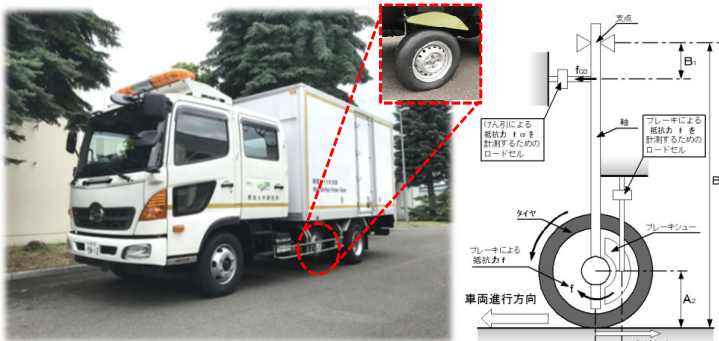
▲路面すべり計測車および計測輪
