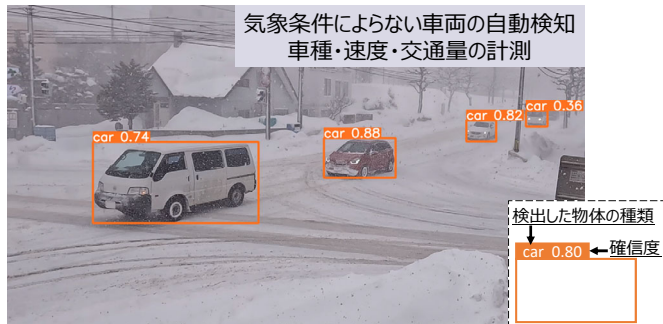
▲ 冬期の交差点状況(新雪)とAIによる車両の自動検知
