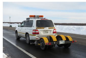
▲ 連続路面すべり抵抗値計測装置
