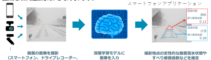
▲ 深層学習とカメラを利用した路面雪氷状態推定システム
