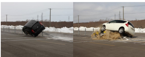
端末部衝突試験状況(左: 緩衝体無し、右: 緩衝体有り)
