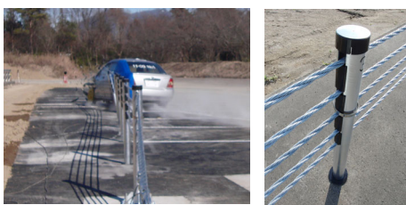
車両が受ける衝撃を緩和 ▲ ワイヤロープ式防護柵 細い支柱
