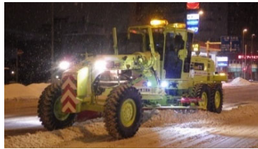
除雪グレーダによる除雪状況
