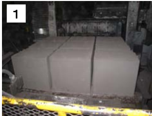
※1 各材料を混ぜ ブロック状態に製作
