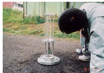
現場透水量試験
