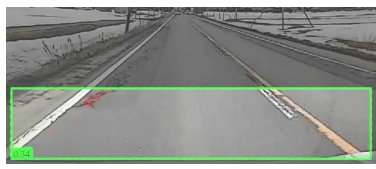
検出漏れの例(偽陰性、ポットホールを見落とし)
