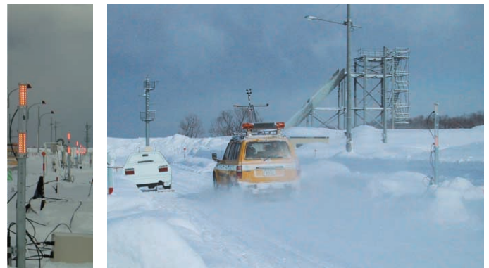
パイロットシステムでの発光警告と実車実験
