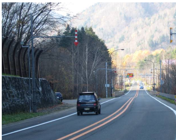
写真4-3-8 固定式視線誘導柱の標準的な矢羽根と道路景観に配慮した矢羽根の設置例
