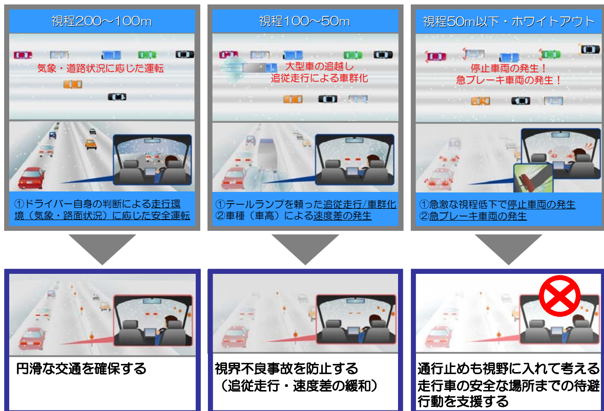
図4-3-1 視程障害の程度に応じた交通の流れと道路の管理水準の考え方
