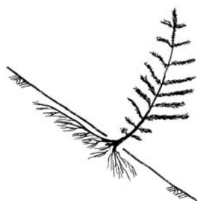
図2-4-41 斜面での根系分布模式図
