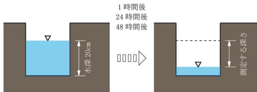
図1-4-40 試坑を利用した透水性試験（植栽基盤整備技術マニュアル 42) を参考に作成）
