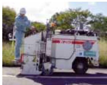
写真3-1. ランブルストリップス施工専用機
