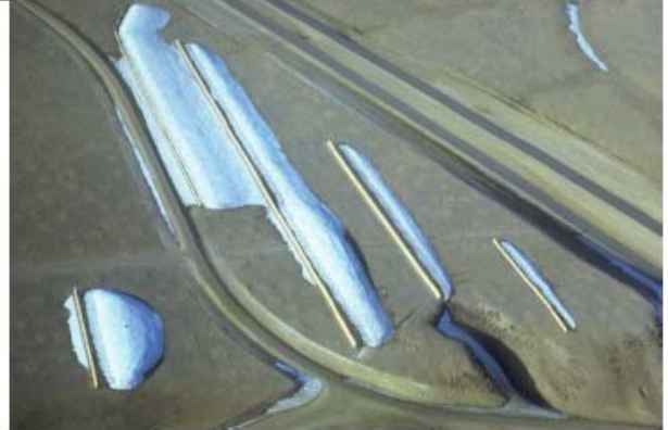
図 2.7 防雪柵設置前のワイオミング I-80、280.8 マイル地点の積雪状況（左）と、防雪柵設置後 31 年間の続いた積雪状況（右上）。この地点の空中写真（Tabler 1973a）。
