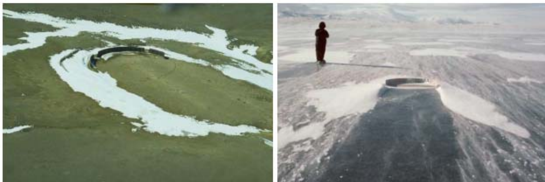
図 6.67. 家畜避難施設の周りの吹きだまりの鳥瞰図（左、R. L. Jairell 氏撮影）。この家畜避難施設の 1/30 模型では、風下側の積雪状態、側方防雪施設の有効性や翼状に広がる吹きだまりを示している。
