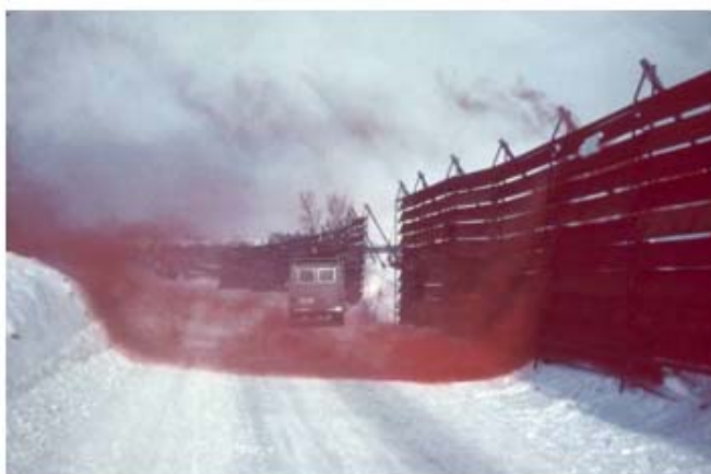
図 6.64. 大きな吹き払い型防雪柵の吹きだまり防止効果は、1974 年に北海道開発局によって図化されている（P19、Tabler1994）。なお、写真は北海道開発局の打矢徹也氏撮影。
