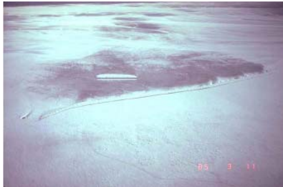
図 2.18 この順風方向からの空中斜め写真は柵の効果が非常に長い距離持続することを示す。前部にある 3.8m の柵は流入する雪の大部分を捕捉している。風を風速減衰効果の増加は風下の雪をおよそ 1km に亘って除去する。雪のない区域に立つ短い柵はメインの柵の雪を捕捉率を計測するために設置された。
