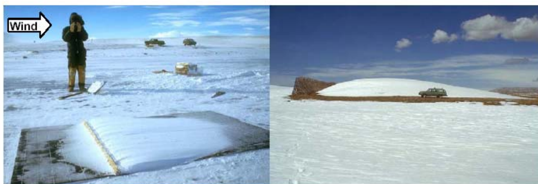
図 3.40 柵高 1.8-m の防雪柵の縮小モデル(柵高 6cm)(写真左)によって形成された平衡状態の吹きだまりは、柵高 3.8m の柵によって形成されたものに比例している (Tabler 1986)
