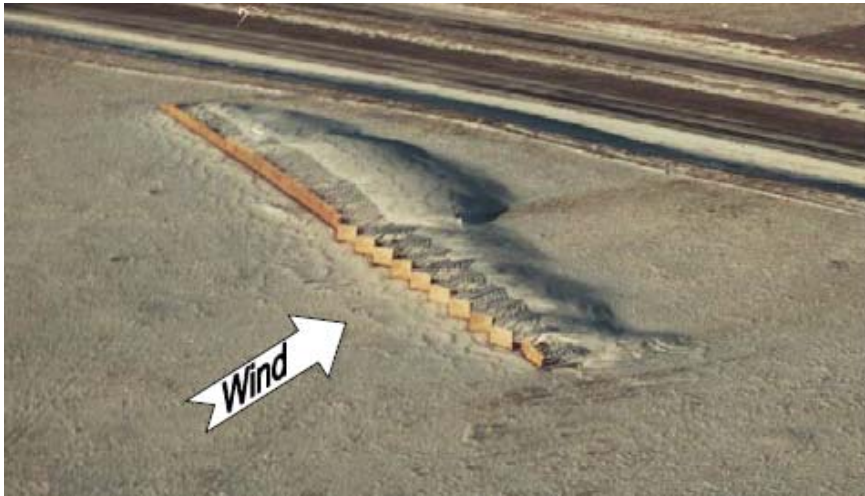
図 6.22 標準的なワイオミング型防雪柵よりもジグザグ形状防雪柵がより少ない防雪容量であることを示す空中写真．これらの柵は比較のため設置された（Tabler 1986b）．柵高は 3.8m(12.5ft)．写真は Robert L.Jairell の厚意による（Tabler 1994）．
