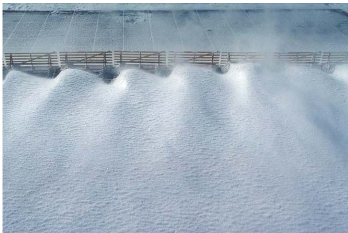
図6.82. ワイオミング柵の模型。柵高1.8m、パネルの間隔15cm、板の間隔(板の芯々間で)30cm(風上に向かって撮影)。パネルの間隔を15cm開けることで、柵の効果がいかに低減するかに注目。
