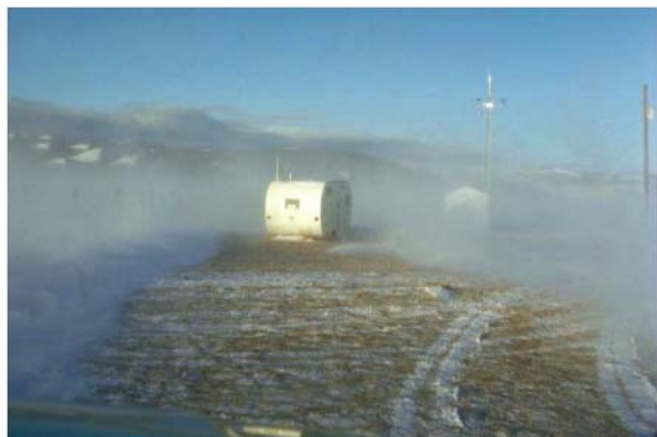
図 6.66. 構造物の後方では飛雪がなく、そこを吹雪が避ける様子 (Tabler, 1984) (高さ 2.4m、幅 2.2m、長さ 5m のトレイラーを風下側から撮影)。
