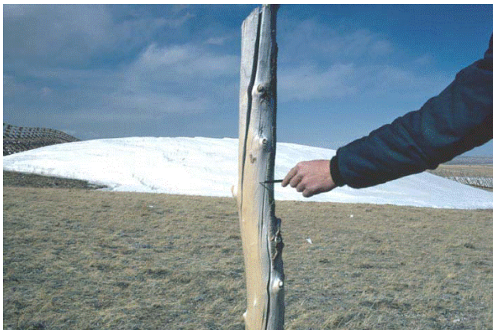
図4.7 木の棒の摩耗模様は、吹雪時の卓越風向を示している (Tabler 1986)。
