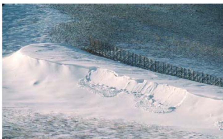
図 3.32 3.8m高さの防雪柵の後方にあるスリップ・フェースと雪庇(Tabler1994)。雪丘の深さは雪庇位置で約 3.7m。
