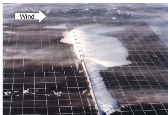
図 5.16 この 1/30 スケール屋外モデルは、box-beam ガードレール（手前側）による吹きだまりは W-beam レール（奥側）よりも少ないことを示している。（Tabler and Jairell 1980）。どちらのモデルも縁石を含む。
