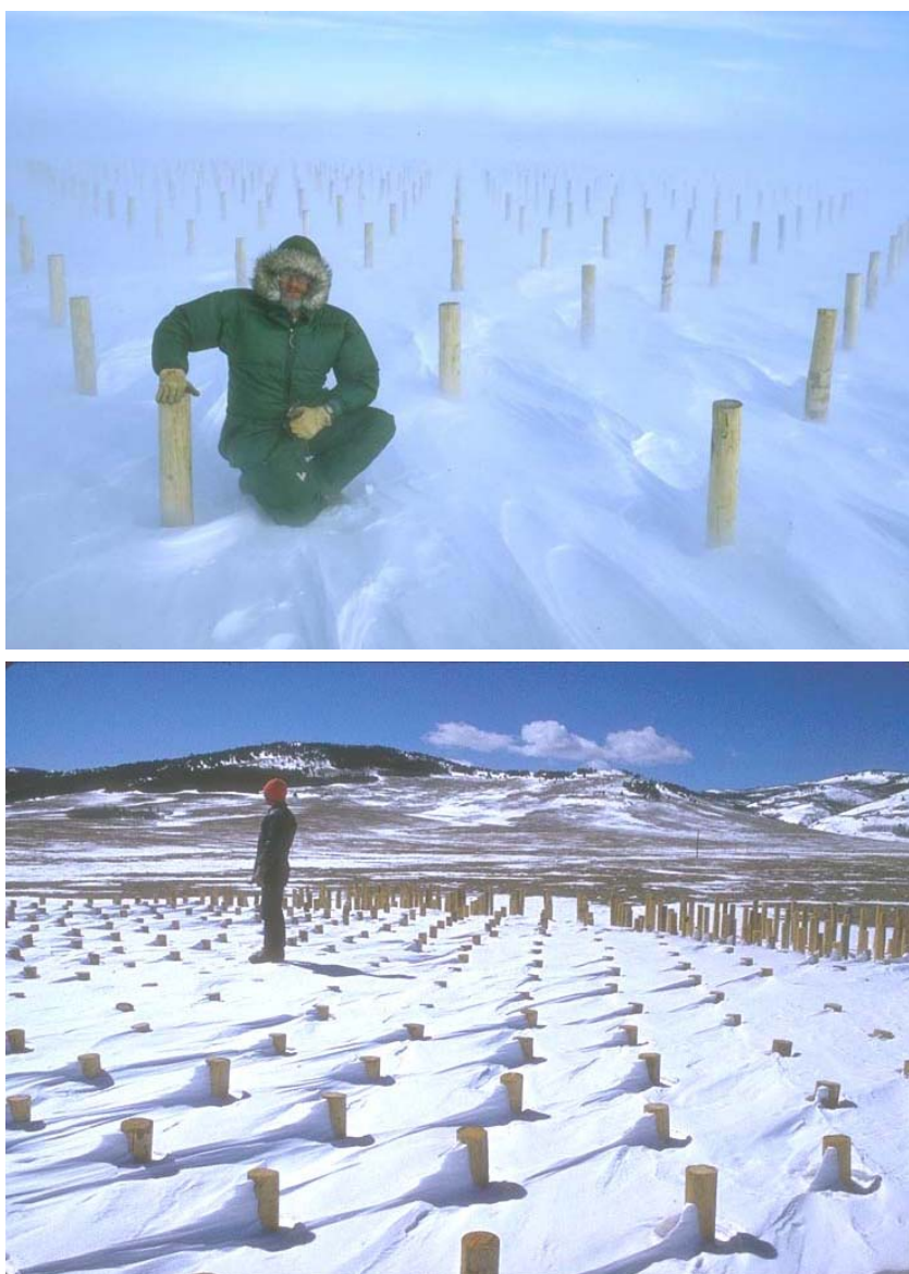
図3.23 直径130mm、高さ1.2m、間隔の異なる柱で保持された雪。表面の粗さの形状が雪の堆積をいかに制御するかを示している (Tabler 1994)。
