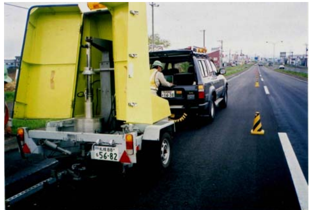
写真-1 FWD 測定車によるたわみ測定
