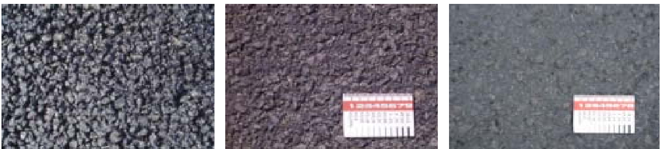
《標準排水性舗装：充填割合0%》
