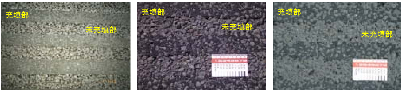
《開粒度充填舗装：充填割合100%》
