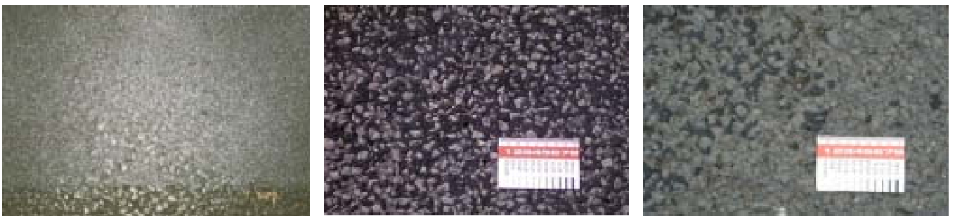
《開粒度充填舗装：充填割合100%》
