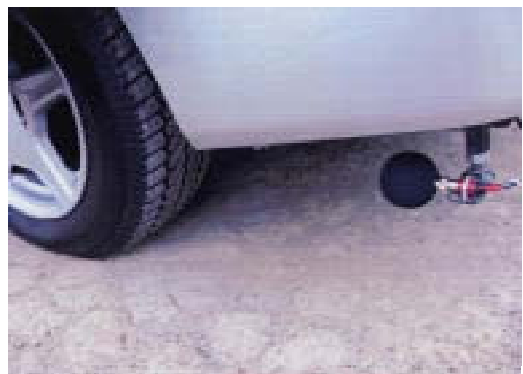
写真-5 マイクロフォン設置状況
