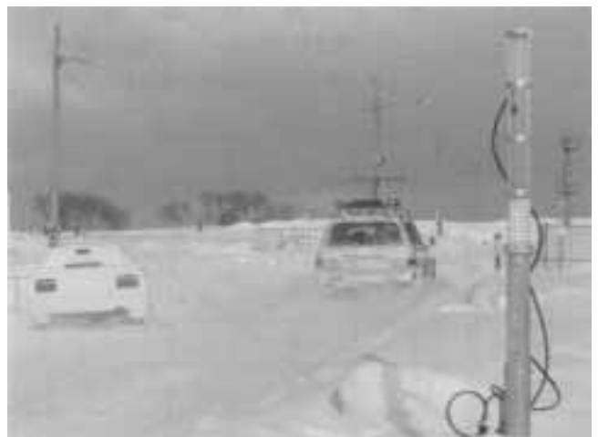
図6. 実車実験状況。右が試作した自発光テリネータ、左が停止直面を想定した権限版。
